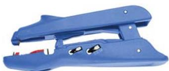
Tipo combinato. Per togliere automaticamente il rivestimento isolante di fili conduttori e per fissare capicorda. Corpo in materiale sintetico rinforzato con fibra di vetro. Lame in acciaio. Lunghezza di spelatura mm 5. Tagliafilo incorporato. Per capicorda isolati da mm<sup>2</sup> 0,5 a 2,5 e mm<sup>2</sup> 4 a 6.
